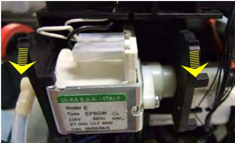
Dégager la pompe des guides des supports en caoutchouc
