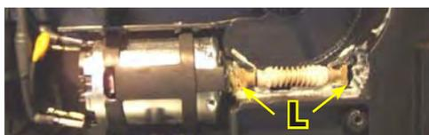
Installer le moteur et l'arbre de transmission en enfonçant les guides (L) dans leur logement
