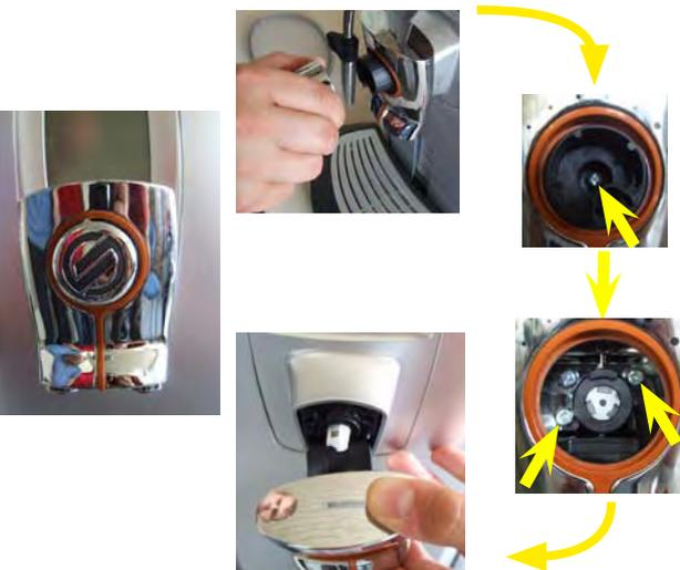
Pour dégager l'habillage du distributeur de café, suivre la procédure dans le sens des aiguilles d'une montre, ôter le pommeau du système SBS, desserrer la vis centrale et enlever le support du pommeau, desserrer les vis indiquées
