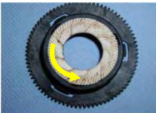
Pour dégager le broyeur, le tourner dans le sens inverse des aiguilles d'une montre jusqu'à ce qu'il se détache du joint à baïonnette.
