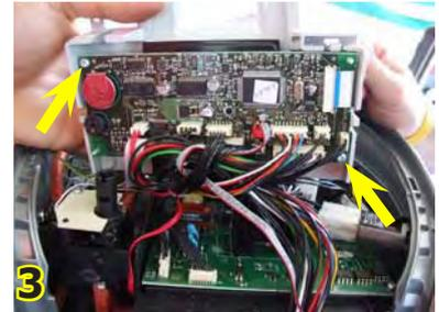
Fig.1 Desserrer les vis indiquées et tourner le bandeau vers le haut pour accéder à la carte
