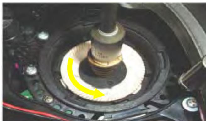
Bloquer l'axe d'augmentation indiqué dans le broyeur inférieur puis procéder comme sur la figure précédente.
